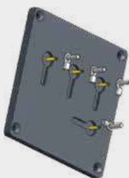
Przykład mocowania tytanowych czujników stykowych dopasowanych do niestandardowych pozycji dyszy
